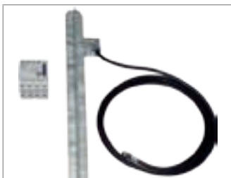
Автоматический предохранительный выключатель тока утечки с заземлительным комплектом Для дополнительной защиты от опасных токов. Заземлительный комплект содержит: заземлительные штырь и кабель.
