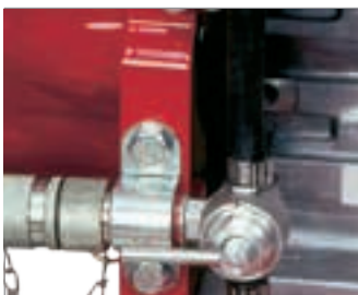
3-ходовой топливный кран Для непосредственного соединения с заправочной системой.
